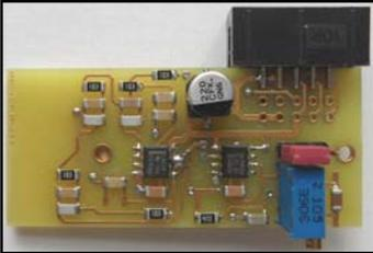
Durch dieses Modul wird die Funktionalität der bereits vorgestellten Baugruppe „Soundmodul SDM“ entscheidend erweitert. Neben dem direkten Zugriff auf eine der bis zu 255 Dateien, die in unterschiedlichen Modi abgespielt werden können, ist eine Zusatzbaugruppe verfügbar. Mit dieser ist ein NF-Verstärker sowie eine Filterstufe verfügbar, die den Klang verbessert und damit den Einsatzbereich des Soundmoduls erweitert.
