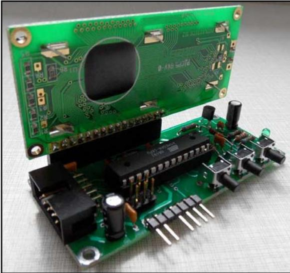
Die heutzutage verfügbaren LCD reduzieren bereits erheblich den Aufwand, Informationen visuell auszugeben. Einen Wermutstropfen gibt es aber dennoch: Auch im 4-Bit-Betrieb benötigen diese Module mehrere Signalleitungen.
