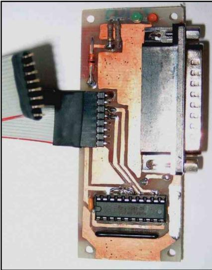
Bauanleitung für eine universell einsetzbare Baugruppe, mit der man Mikrocontroller der AVR-Serie (Atmel) unter Verwendung der Brennsoftware WinAVR programmieren kann.
