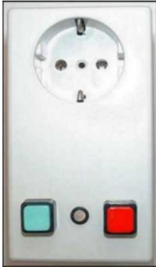
Bauanleitung einer frei programmierbare mikrocontrollerunterstützte Temperatursteuerung für Lötkolben oder andere "träge" Verbraucher, die sich über eine Impulspaket-Steuerung in ihrer Leistungsaufnahme steuern lassen.
