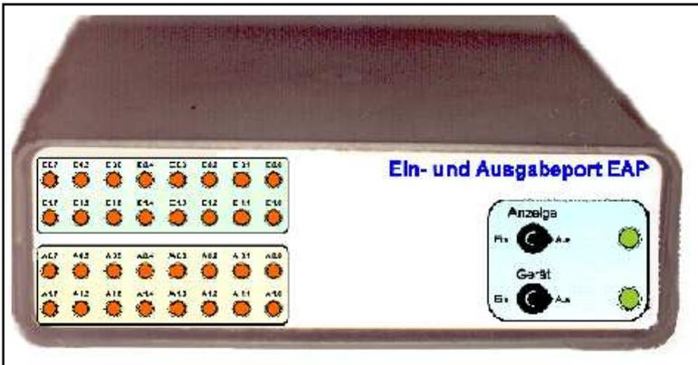
Bauanleitung für eine digitale Ein- und Ausgabebaugruppe zum Anschluß an die parallele Schnittstelle
